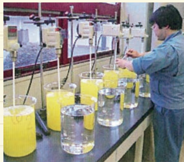
ゲルマニウム半導体検出器により放射能の測定・分析作業を行っている様子。測定をする放射性物質を化学的に分離させ(右)、放射線がどれくらい出ているか測定を行っています(左)。 【写真提供】(財)日本分析センター
