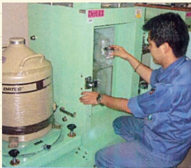
ゲルマニウム半導体検出器により放射能の測定・分析作業を行っている様子。測定をする放射性物質を化学的に分離させ(右)、放射線がどれくらい出ているか測定を行っています(左)。 【写真提供】(財)日本分析センター
